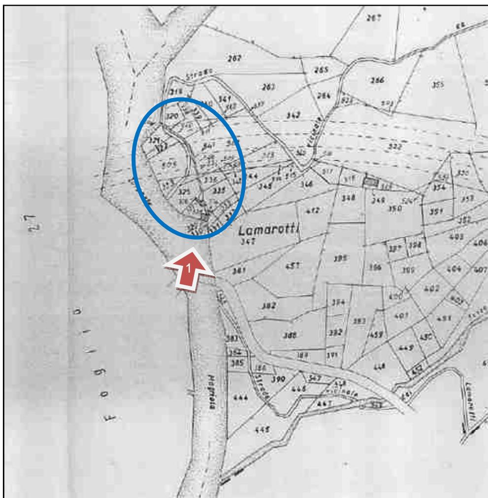
Figura 36 - Tracce catastali di antichi mulini sul Torrente Magriola nel tratto sotteso - cerchiati in blu in Figura 35. (si noti la "gora", i mulini ed il rilascio nel torrente)
