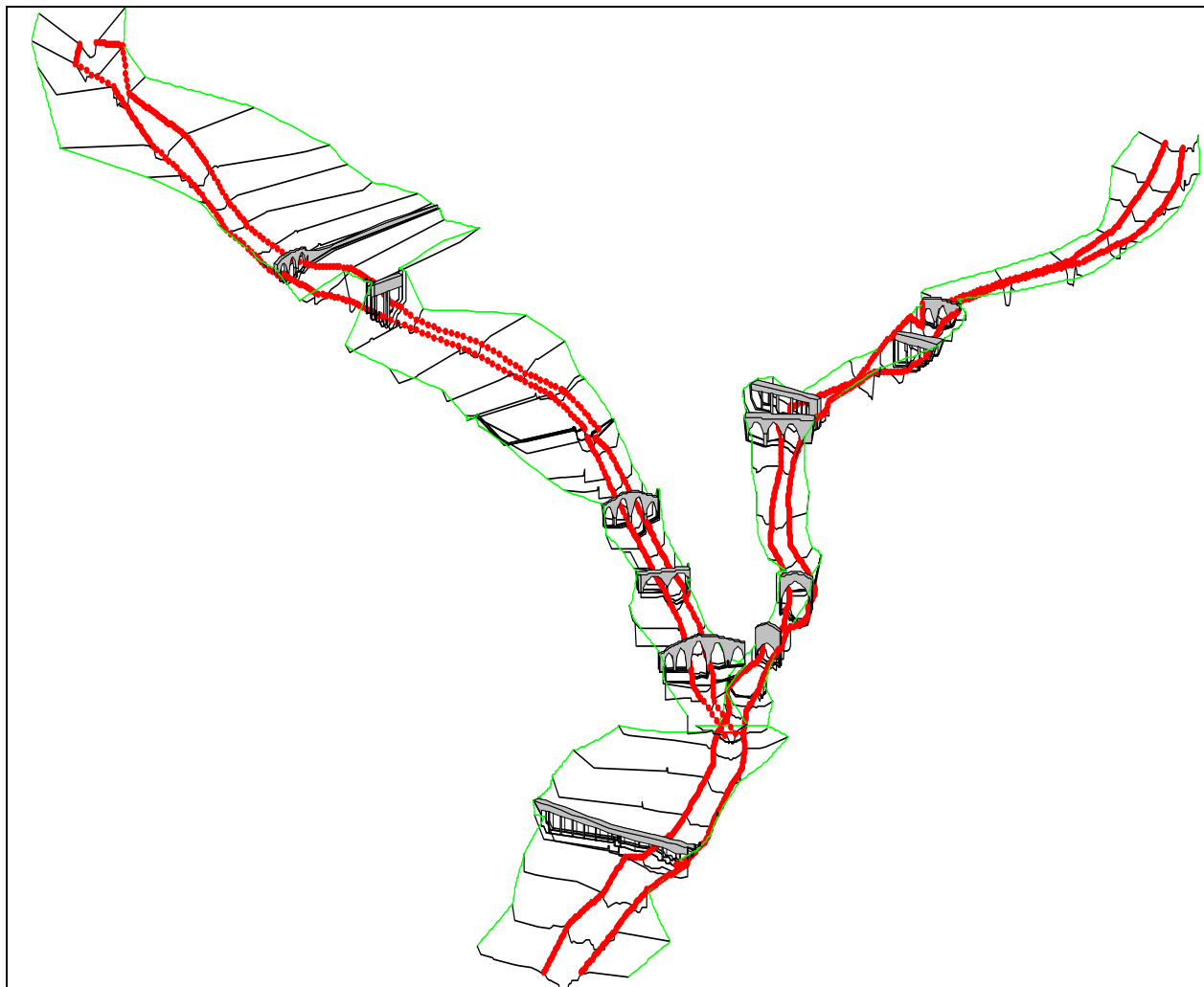
Figura 10 – Estratto 3D del modello idraulico (Hec-Ras 4.0) – dettaglio zona t.Verde e f.Magra fino al ponte Alcide De Gasperi
